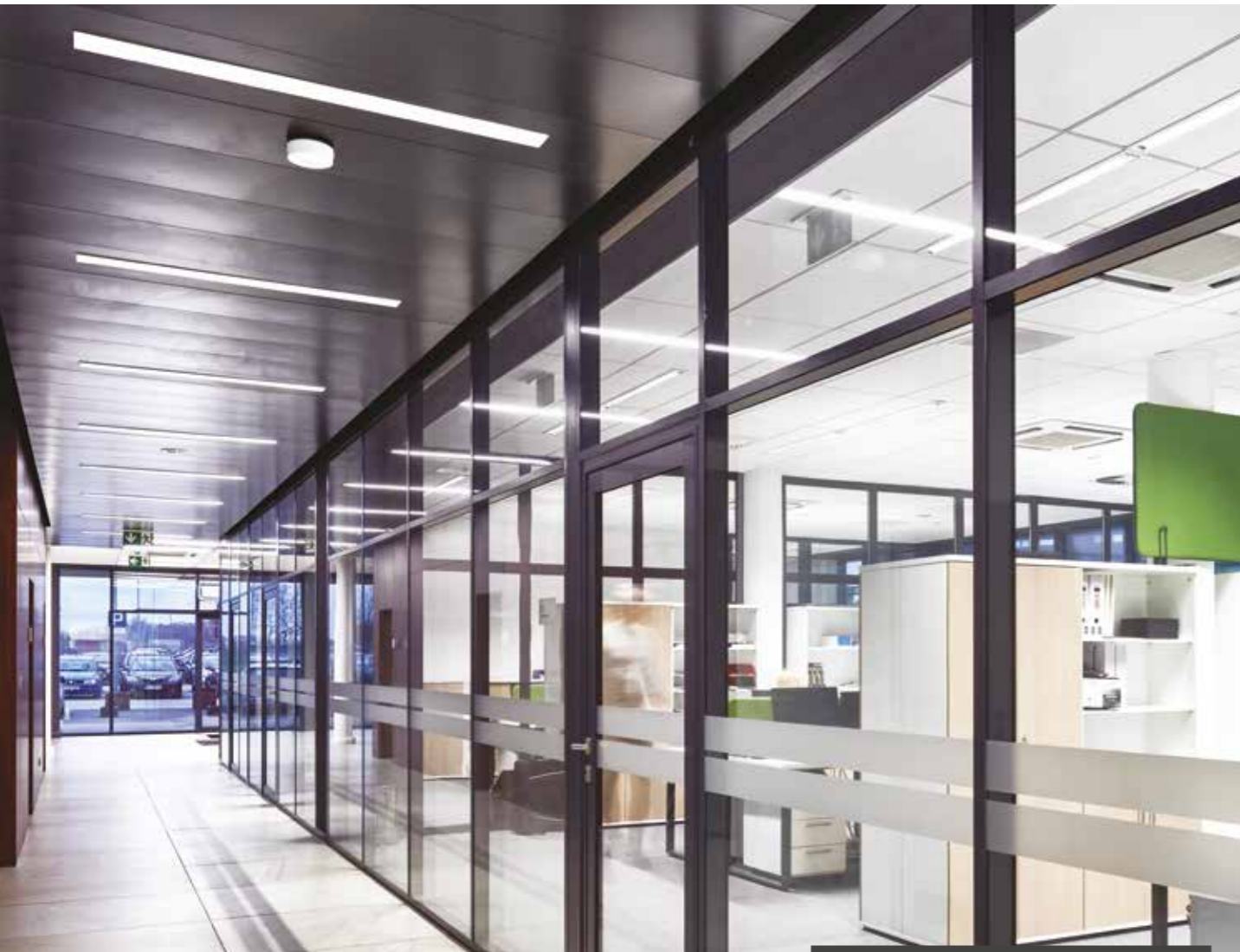
Акустические ламинированные панели Armstrong с кромкой Tegular 15/90 Металлическое потолочное решение Armstrong D-H 700 без перфорации, цвет RAL 7024
