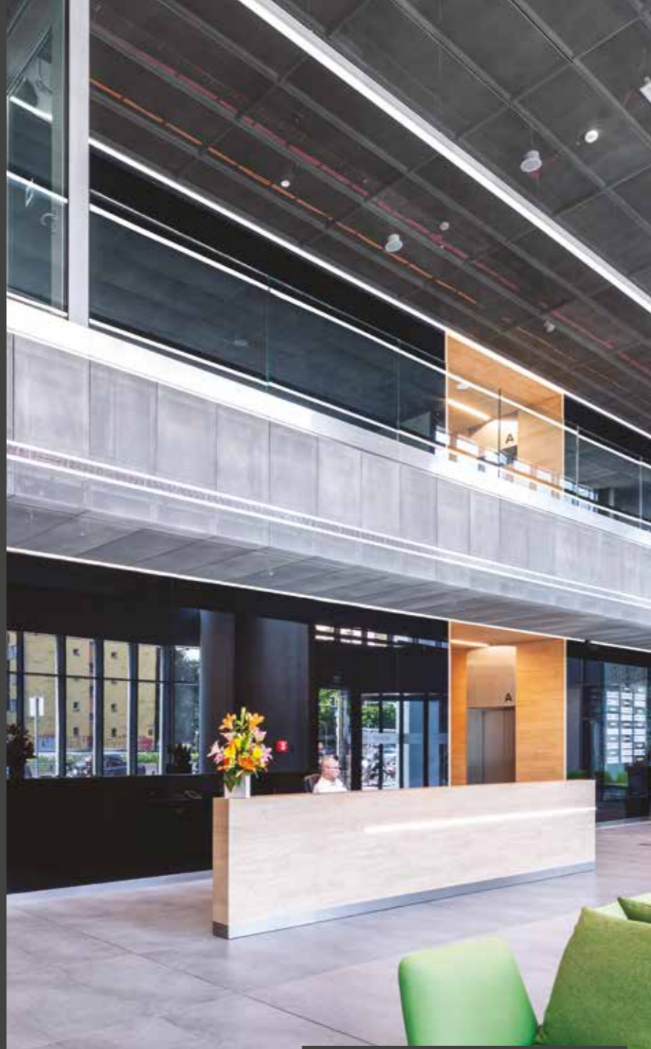
Сетчатое потолочное решение Armstrong Mesh R-H 200, перфорация RB25, цвет RAL 9007 Стеновое решение Armstrong Metal W-H 1000, перфорация RB25
