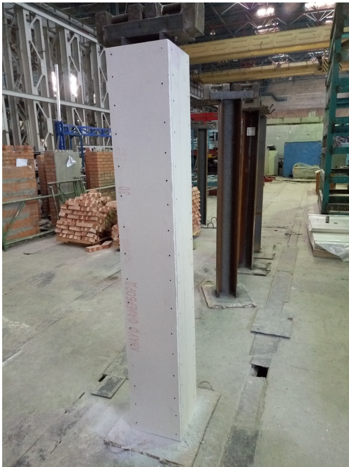
Рисунок 8. Образец №2 - трехслойная облицовка колонны общей толщиной 52.5 мм, выполненная из негорючих плит КНАУФ - Файерборд
