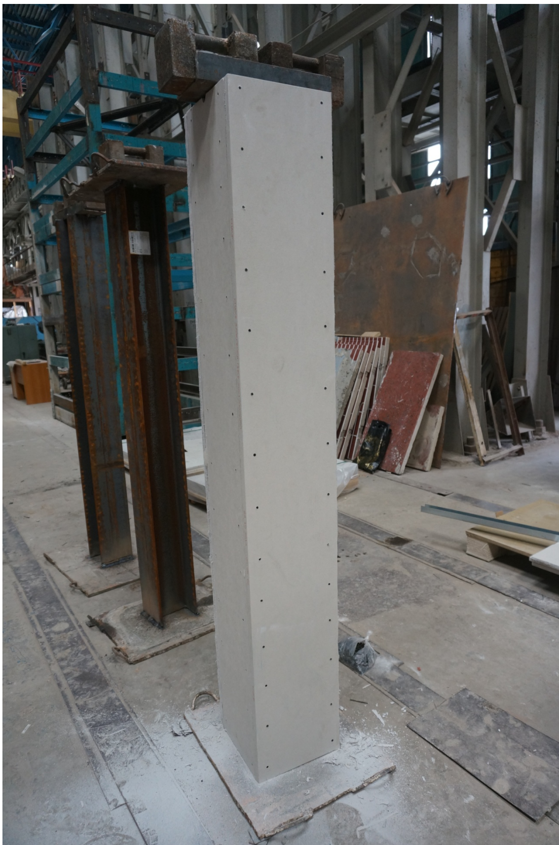
Рисунок 7. Образец №1 - однослойная облицовка колонны толщиной 20 мм, выполненная из негорючих плит КНАУФ - Файерборд
