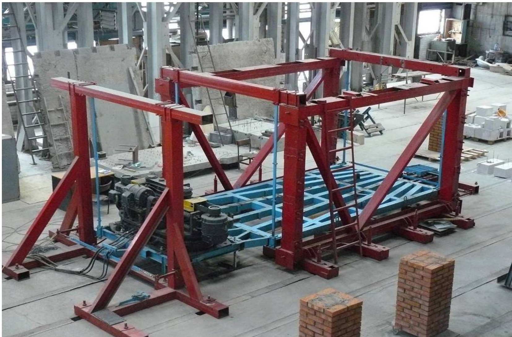
Рисунок 1. Общий вид виброплатформы предназначенной для проведения динамических испытаний.
