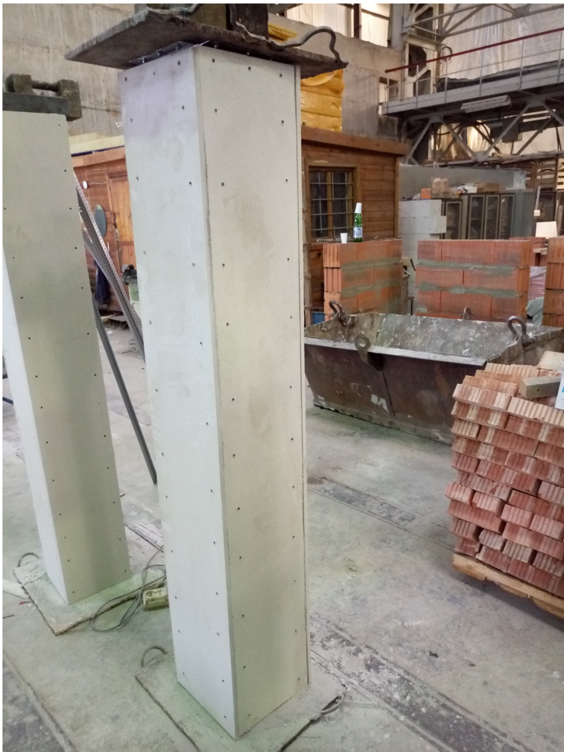
Рисунок 11. Образец №4 - трехслойная облицовка колонны общей толщиной 37,5 мм, выполненная из гипсоволокнистых КНАУФ-суперлистов
