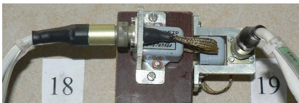
Рисунок 15 Измерительно-вычислительного комплекса МІС - 036 и акселерометр АТ 1105.1 – 5А
