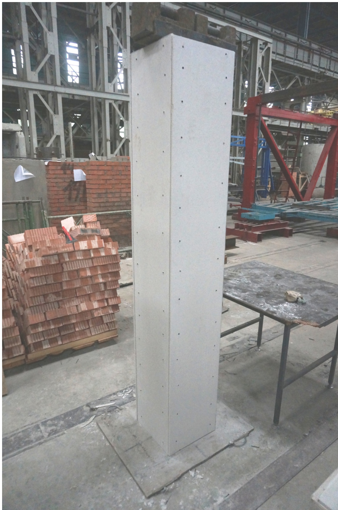
Рисунок 9. Образец №3 - трехслойная облицовка колонны общей толщиной 37.5 мм, выполненная из гипсоволокнистых КНАУФ - суперлистов
