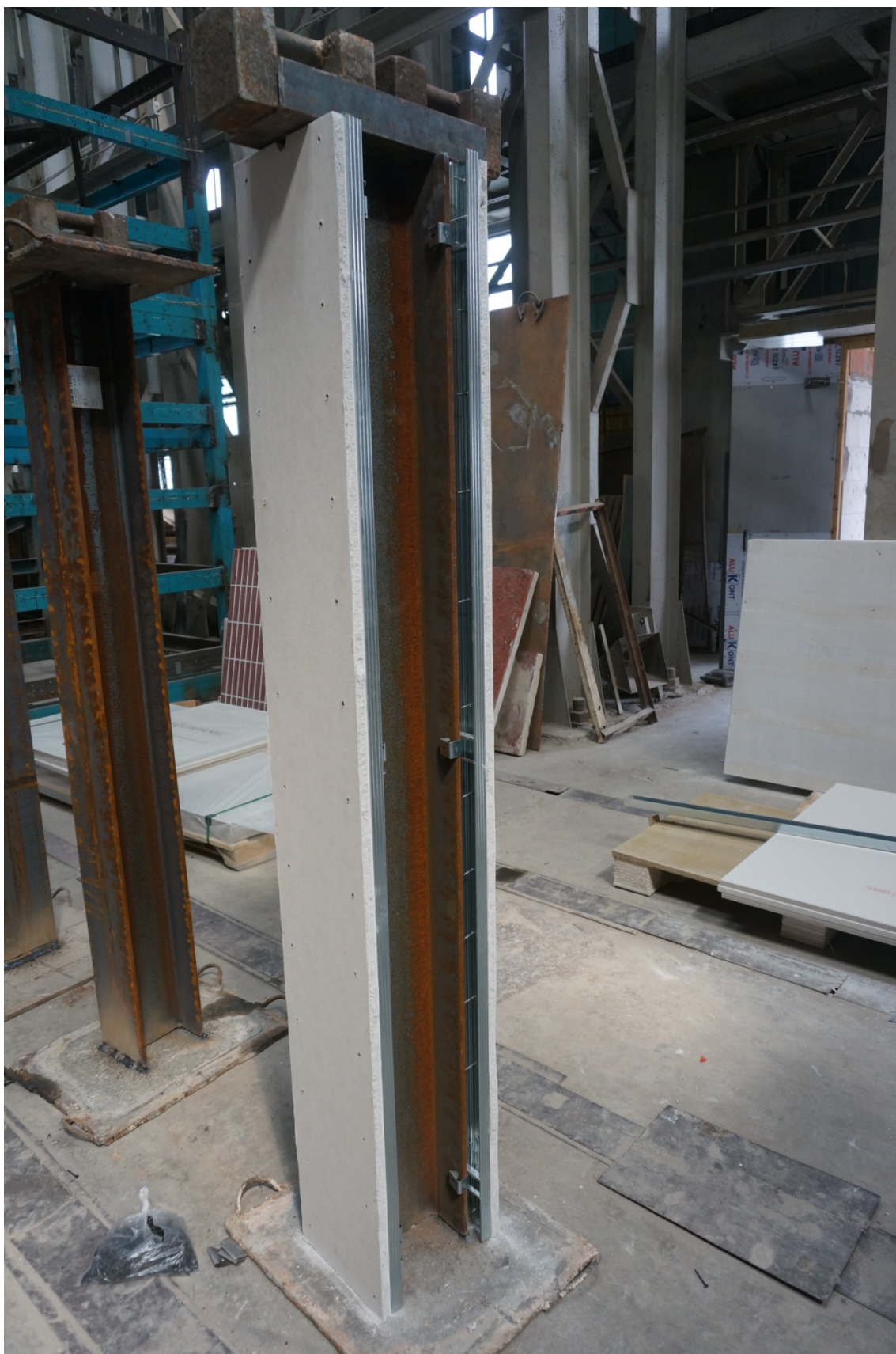
Рисунок 6. Первый слой облицовки закрепленной с помощью самонарезающих винтов к КНАУФ - профиль ПП 60/27
