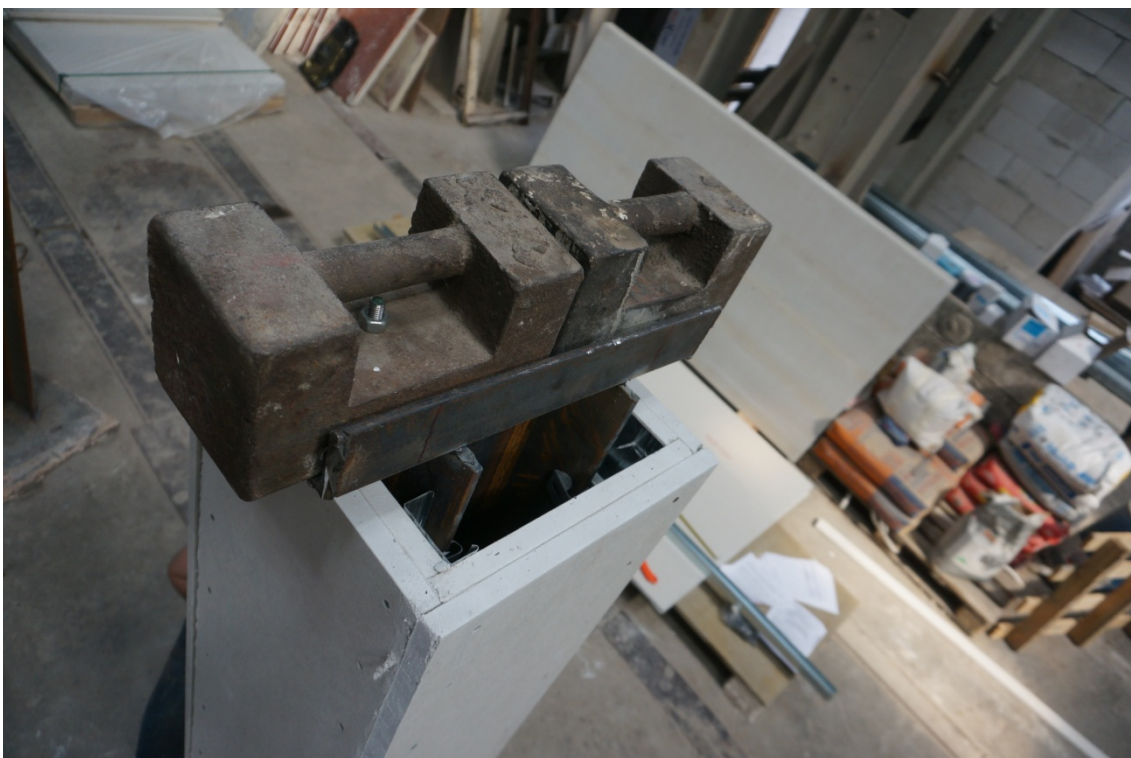
Рисунок 2. Дополнительные грузы массой 40 кг предназначенные для увеличения динамической нагрузки на образцы
