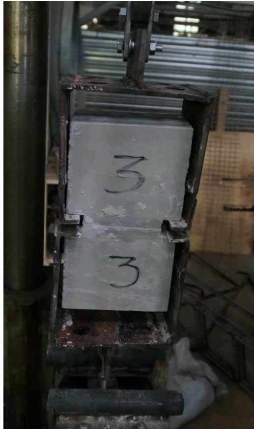
Рисунок 1.8. Общий вид опытных образцов-двоек в испытательной установке
