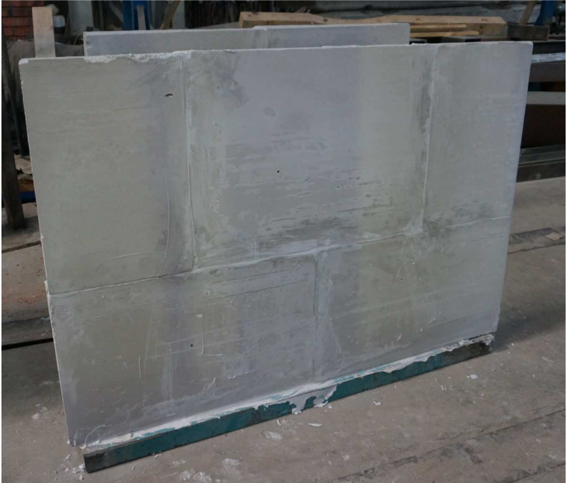
Рисунок 2.16. Общий вид опытных образцов для испытаний на изгиб по перевязанному сечению
