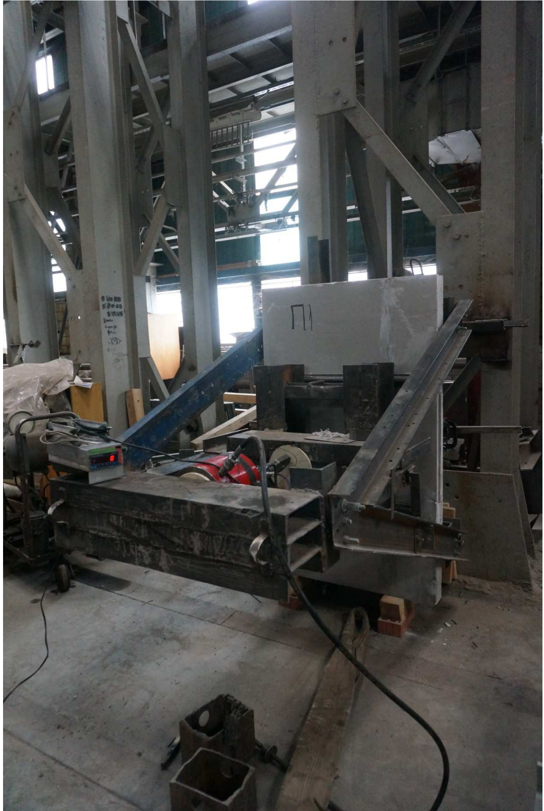
Рисунок 2.1. Общий вид силовой рамы для испытаний на изгиб опытных фрагментов перегородок из «КНАУФ-гипсоплит»
