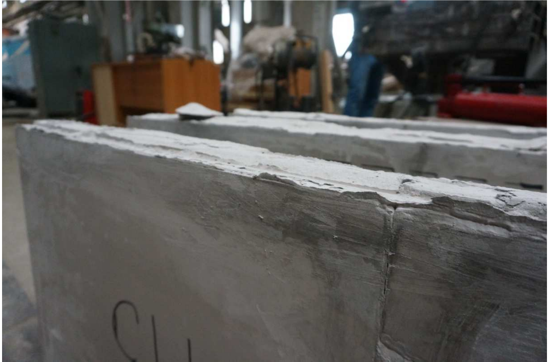
Рисунок 2.13. Характер разрушения опытного образца
