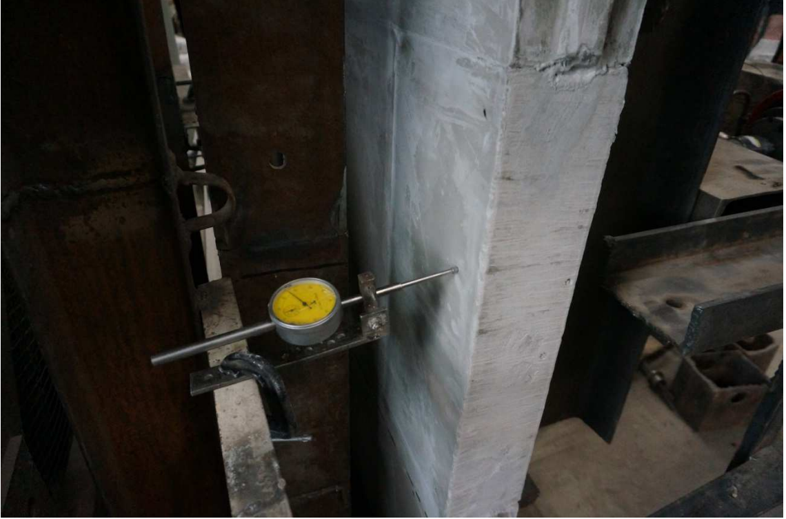
Рисунок 2.7. Индикатор для измерения перемещения плит при изгибе
