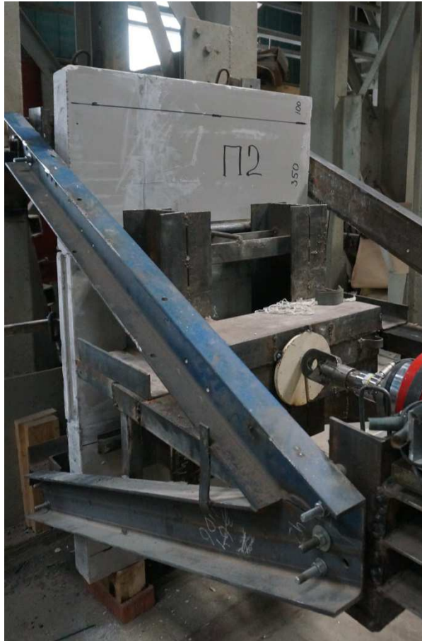
Рисунок 2.10. Стенд для испытаний на изгиб с установленным в нем опытным образцом
