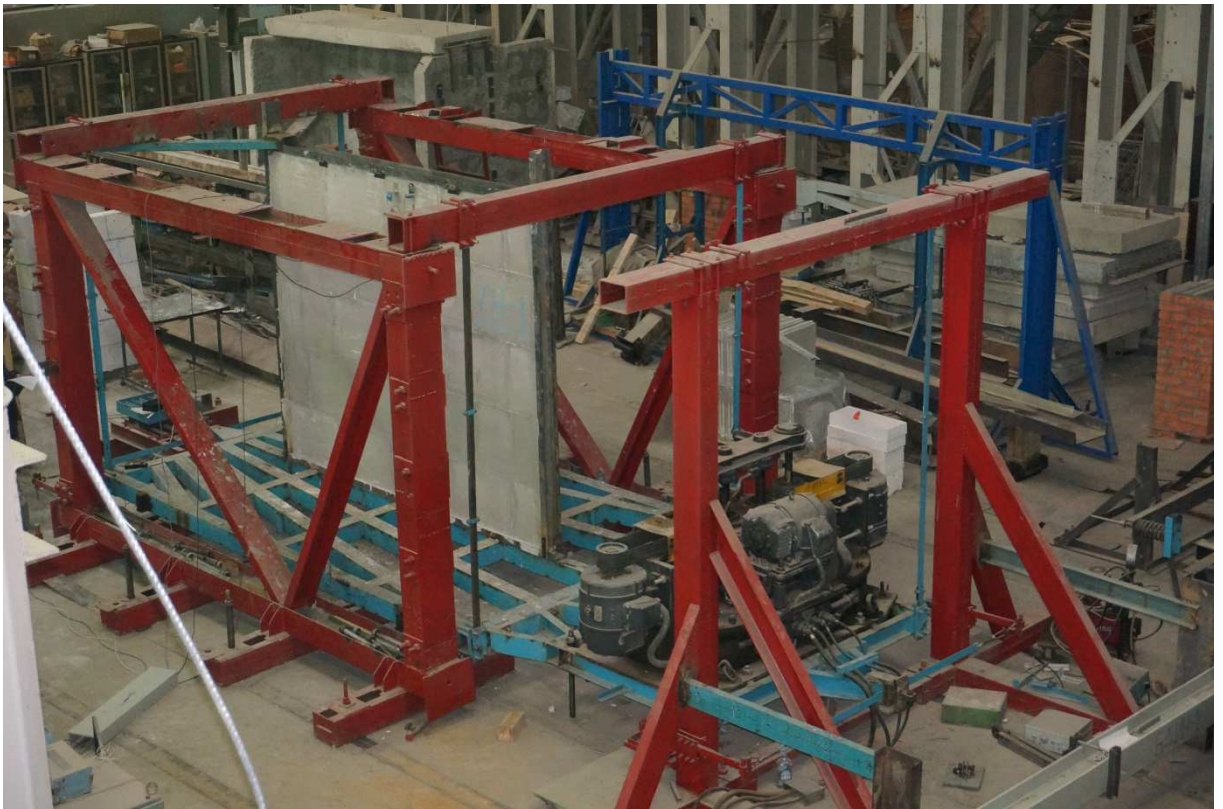
Рисунок 3.6. Общий вид виброплатформы с установленным на ней образцом
