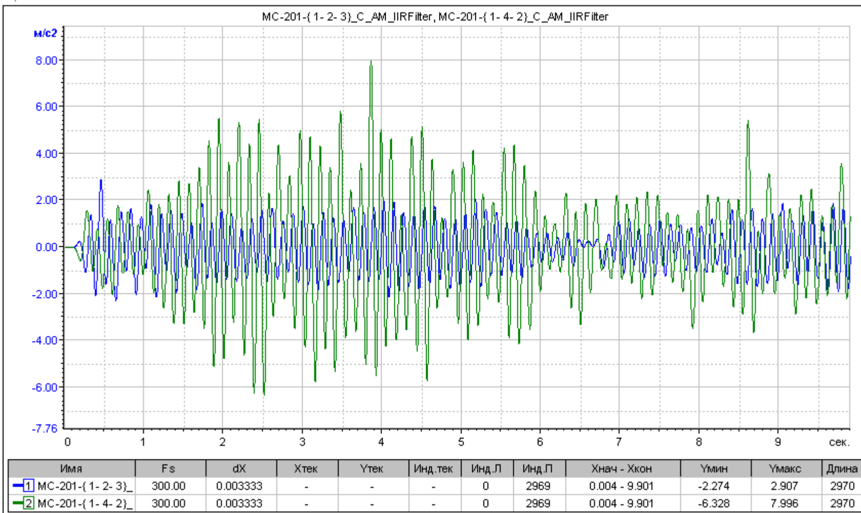
Рис. П1.16 Акселерограмма вертикальных ускорений. Режим 18.
