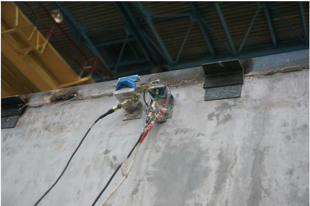
Рисунок 3.9. Места установки контролируемых датчиков (акселерометров) на образцах I и II серий
