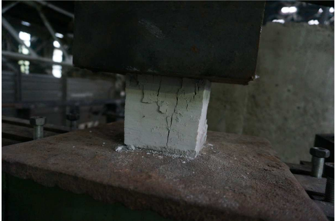
Рисунок 1.4. Испытания кубов из гипсобетона на сжатие
