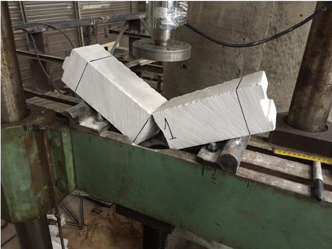
Рисунок 1.5. Испытания призм из гипсобетона на растяжение при изгибе
