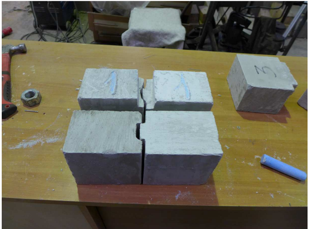
Рисунок 1.10. Характер разрушения образцов-двоек при осевом растяжении
