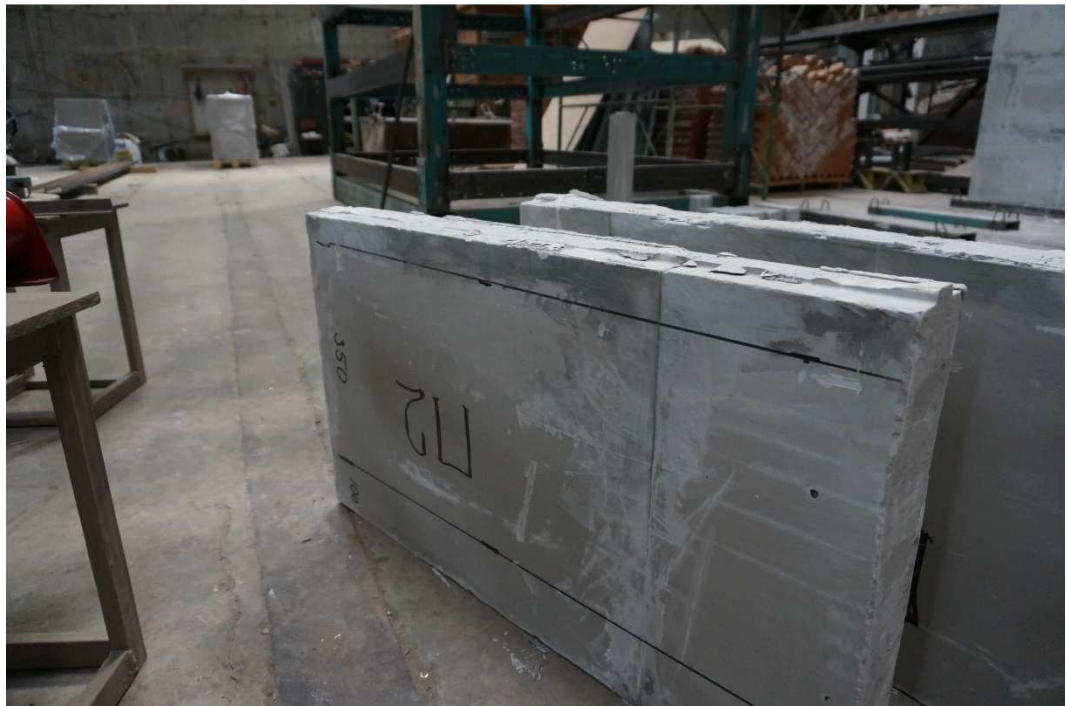
Рисунок 2.12. Характер разрушения опытного образца П2
