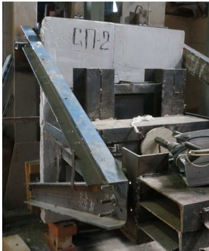
Рисунок 2.17. Стенд для испытаний на изгиб с установленным в нем опытным образцом
