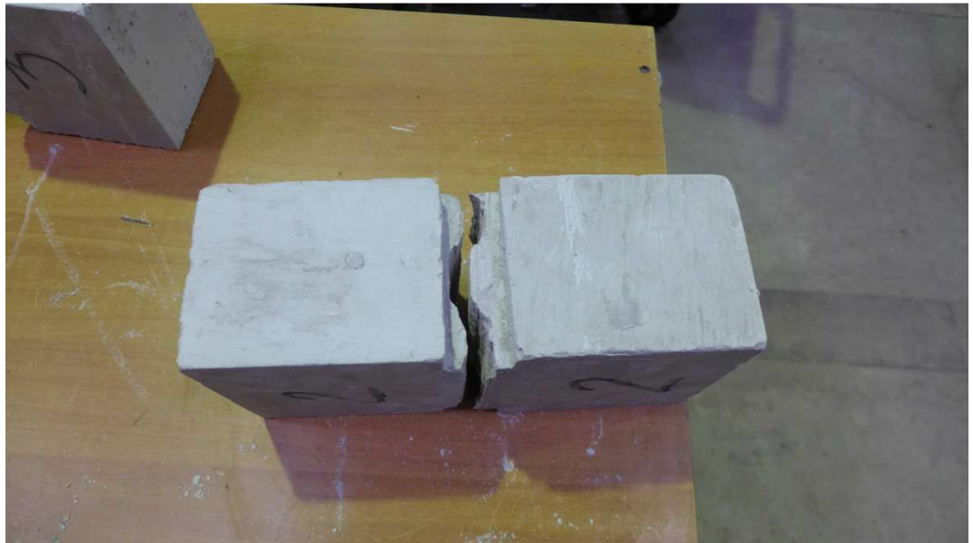
Рисунок 1.9. Характер разрушения образцов-двоек при осевом растяжении
