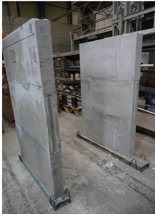
Рисунок 2.9. Общий вид опытных образцов для испытаний на изгиб по неперевязанному сечению
