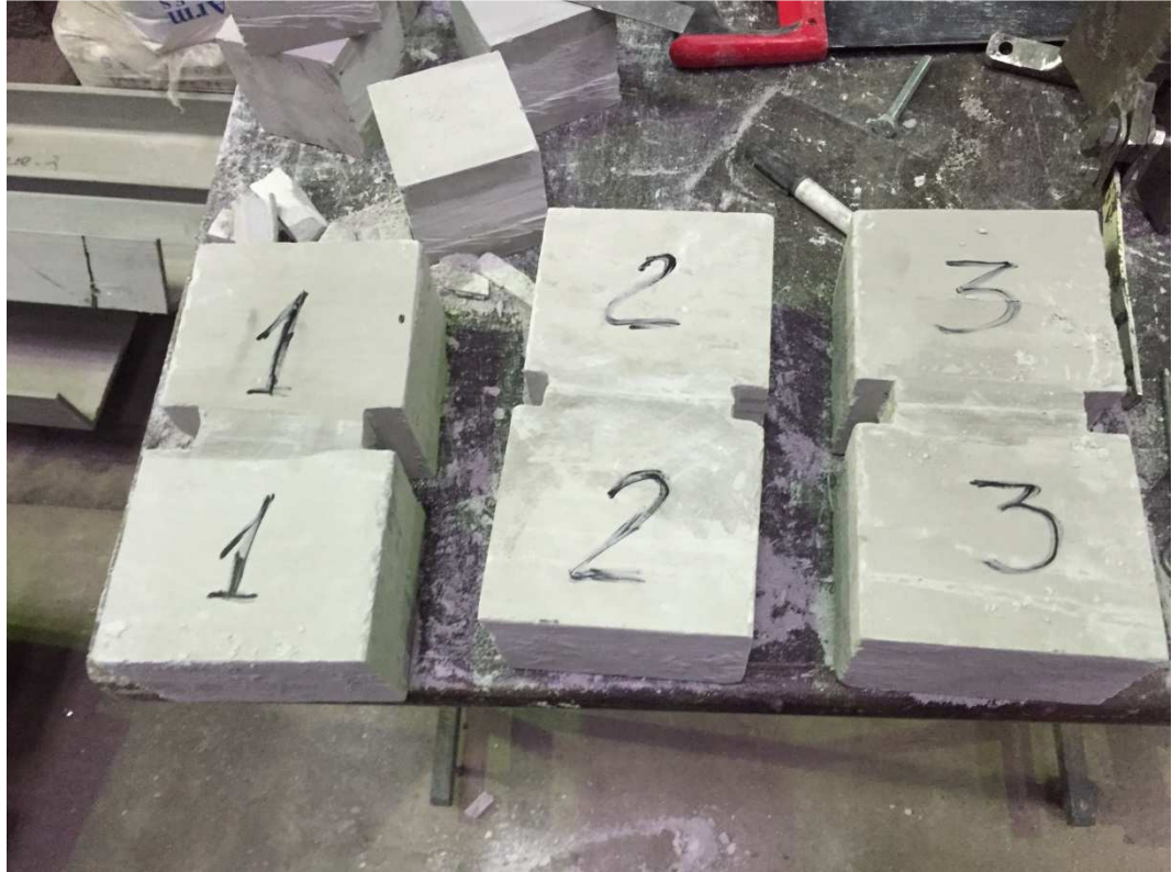
Рисунок 1.7. Общий вид образцов для испытания на осевое растяжение (нормальное сцепление)
