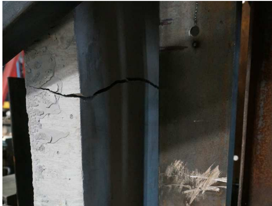
Рисунок 2.18. Характер разрушения опытного образца
