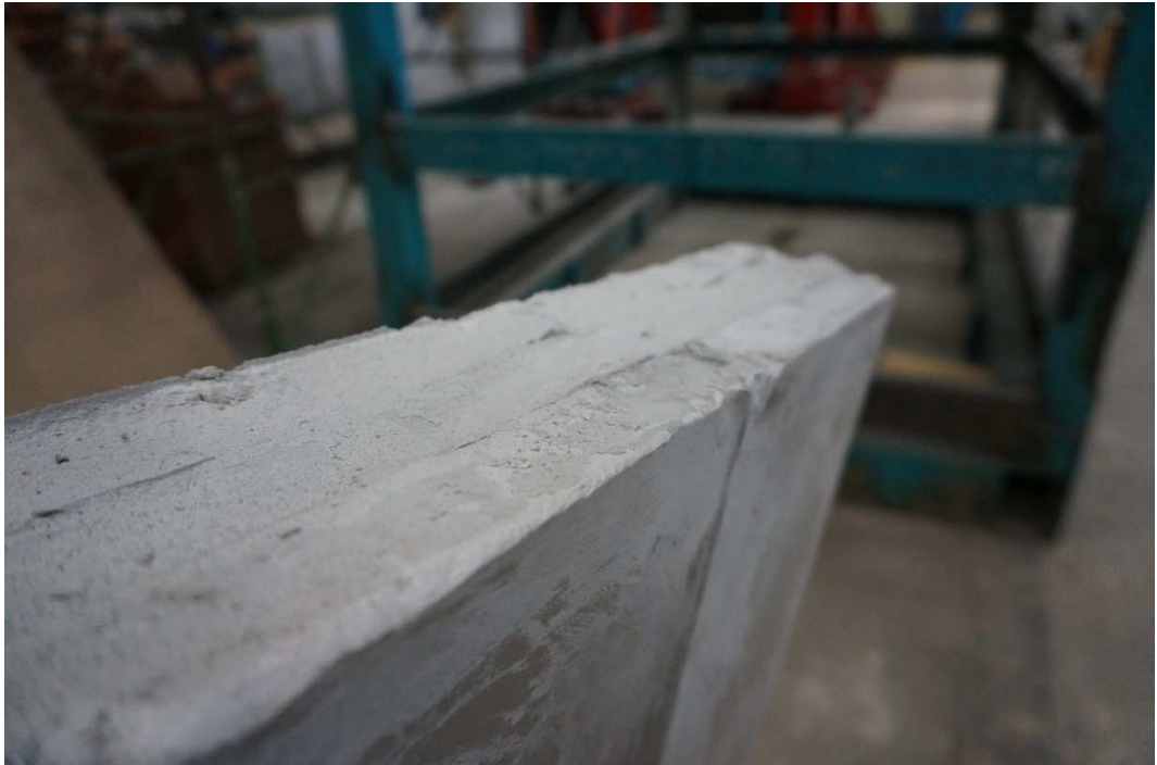
Рисунок 2.11. Характер разрушения опытного образца П1
